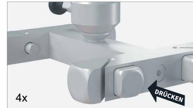
1. Drücken Sie den Druckknopf an der Klemmleiste der Fadenhalterung und halten Sie ihn gedrückt.
