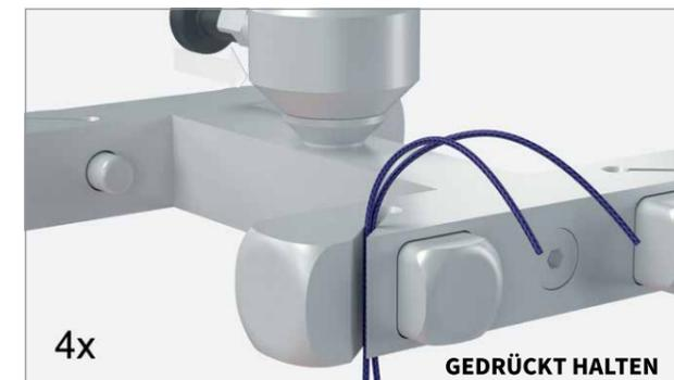
2. Führen Sie jeweils den doppelt geführten Faden durch den jeweils nächstgelegenen Schlitz in der Klemmleiste der Fadenhalterung.
